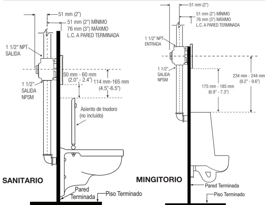
NOTA: No se incluyen las Conexiones de Descarga que se muestran en líneas punteadas.
