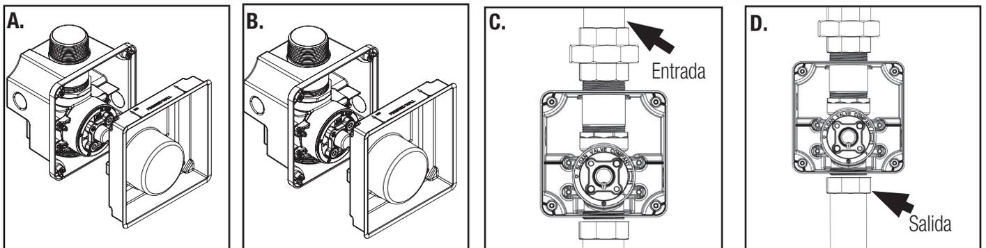
**A.** Descargue suciedad, residuos y sedimentos de la línea de suministro antes de conectar la válvula.
