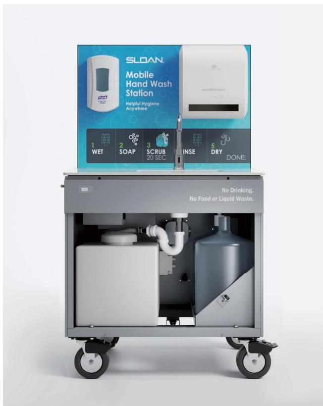
所有洗手台都配备了交流或直流供电装置和 16 加仑的灰水箱。特定型号配备了热水器和可容纳两个 5 加仑水罐的柜架（提供水罐）。
